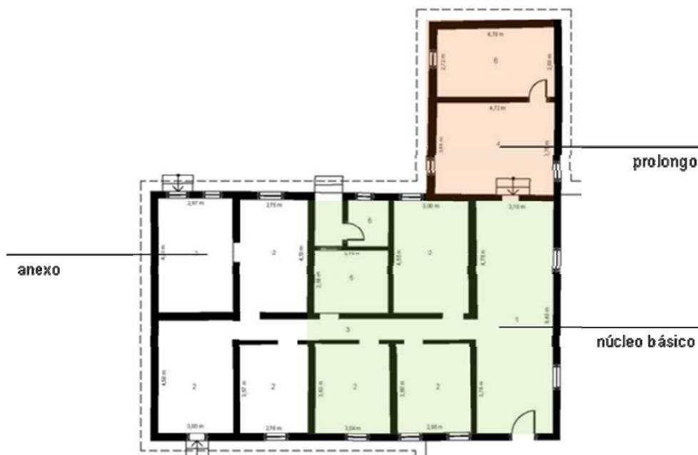
Figura 187 - Planta baixa da morada da Fazenda Gama, destacados núcleo básico, prolongo e anexo.
