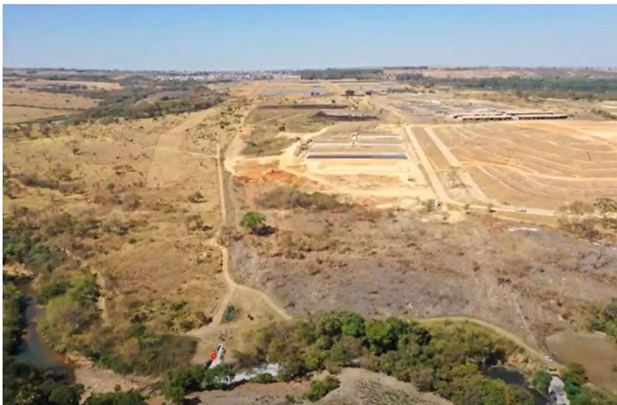
Imagem 25. Pontos de lançamento das ETEs no Rio Melchior. À esquerda inferior, vemos o lançamento da ETE Samambaia, à direita inferior, da ETE Melchior.
